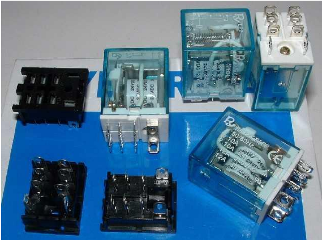
شكل رقم ٩: اشكال مختلفة من المرحلات (Relay)
