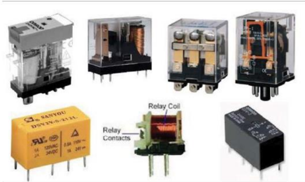
شكل رقم ٧: أشكال مختلفة للمرحلات الكهرومغناطيسية
